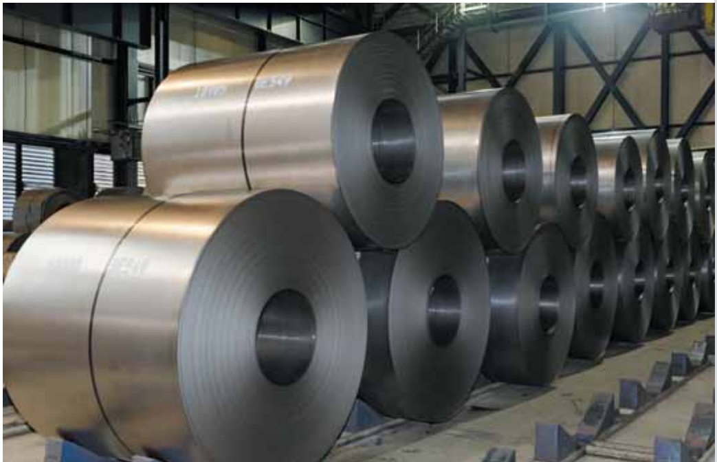
Der fertige Stahl wird als coil in die ganze Welt transportiert.
