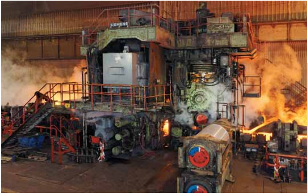
Im Warmwalzwerk wird aus den Stahlblöcken der Gießerei, Brammen genannt, eine dünne, zusammenhängende Stahlplatte von 1,5 mm Dicke gewalzt.
