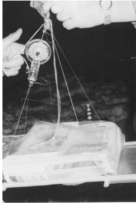
Propagandamaterial wird unter dem Ballon auf einem Trägergestell deponiert, das später über dem Zielort durch einen zeituhrgesteuerten Mechanismus ausgeklinkt und abgeworfen wird.
